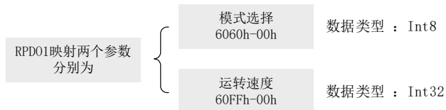
图 3-12 PDO1 映射关系举例
