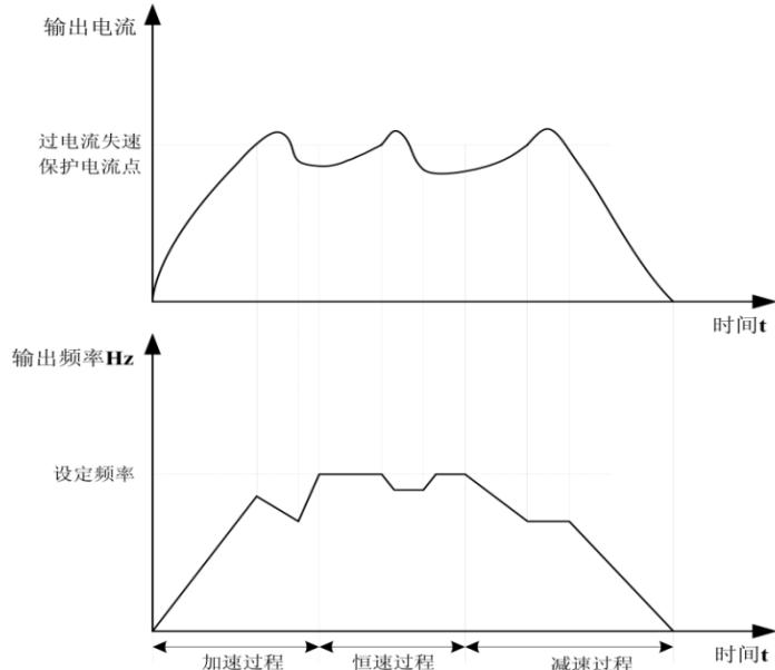
图 P9-1 过流失速保护示意图
