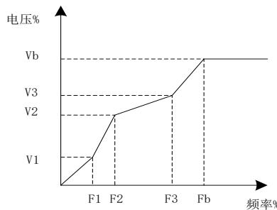
V1~V3：多段速 V/F 第 1~3 段电压百分比 V<sub>b</sub>：电机额定电压
