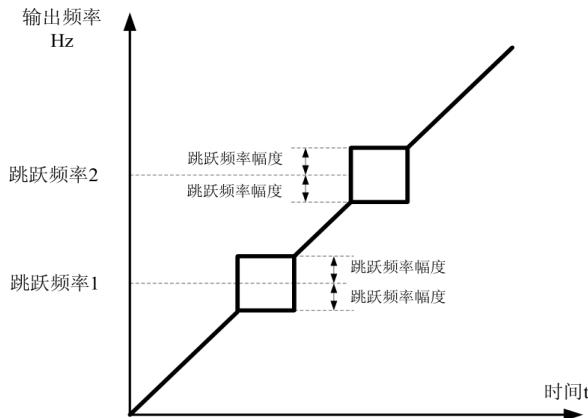
图 P8-4 跳跃频率示意图
