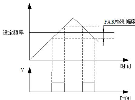
图 P8-7 频率到达检出幅值示意图
