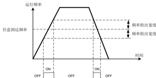
图 P8-9 任意到达频率检测示意图
