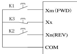
图 P4-4 三线式控制模式 1 示意图
