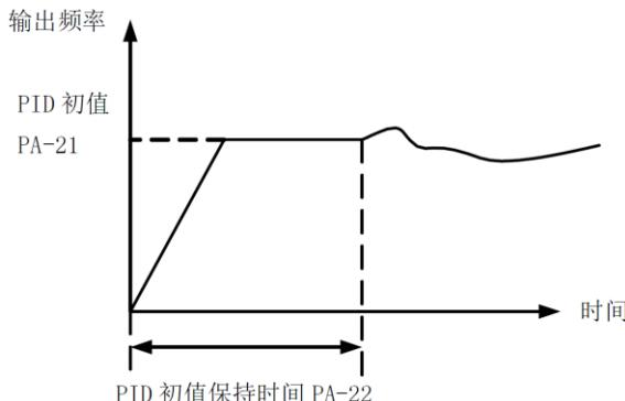
图 PA-2 PID 初值功能示意图
