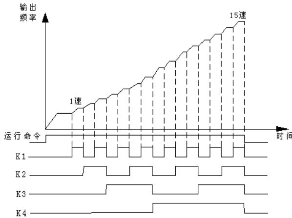
图 P4-1 多段速运行示意图
