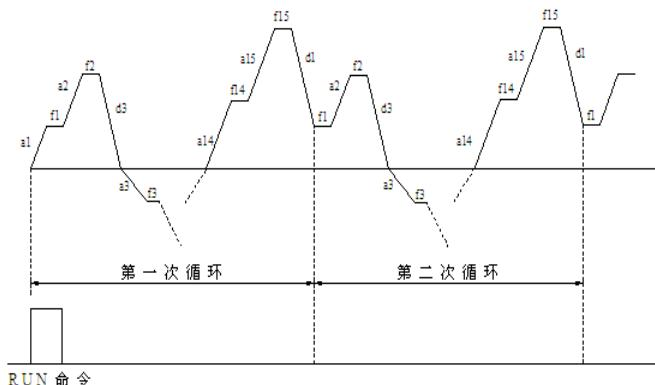
图 PC-3 PLC 一直循环示意图
