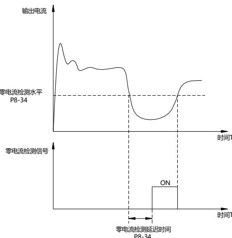
图 P8-10 零电流检测示意图
