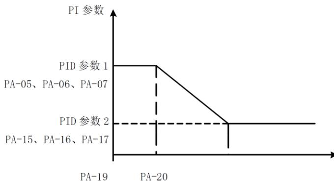
图 PA-1 PID 参数切换
