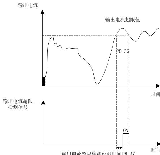
图 P8-11 输出电流超限检测示意图
