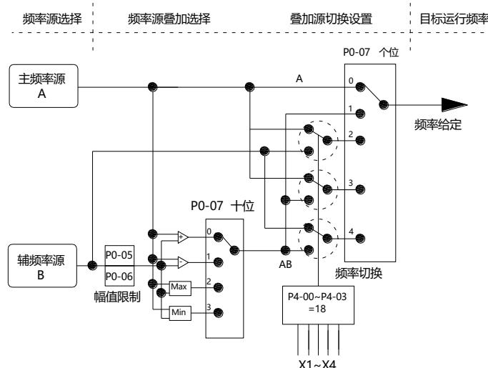
当频率源选择为主辅运算时，可以通过 P0-21 设置偏置频率，在主辅运算结果上叠加偏置频率，以灵活应对各类需求。当频率源选择为“数字设定”或“端子 UP/DOWN”时，该功能码值为变频器的频率数字设定值。
