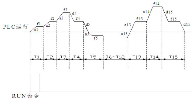
图 PC-1 PLC 单次循环后停机示意图
