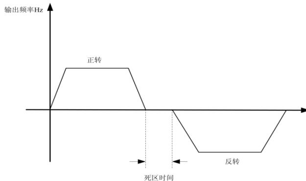
图 P8-5 正反转死区时间示意图
