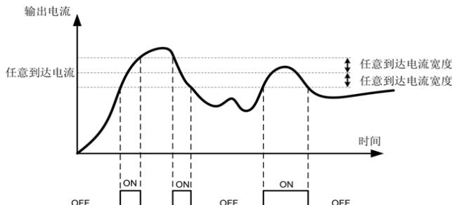
图 P8-12 任意到达频率检测示意图
