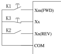
图 P4-5 三线式控制模式 2 示意图
