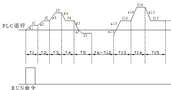
图 PC-2 PLC 单次循环后保持示意图
