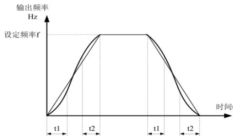
图 P6-1 曲线加减速 A 示意图
