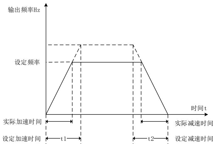
图 P0-1 加速时间和减速时间示意图
