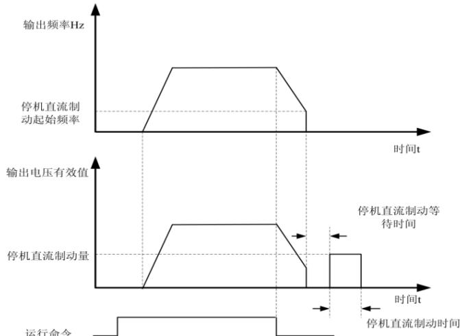
图 P6-3 停机直流制动示意
