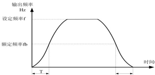
图 P6-2 曲线加减速 B 示意图
