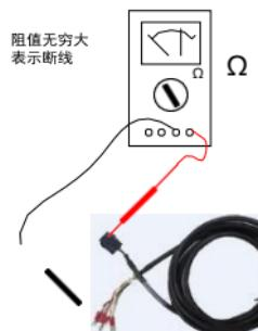
图 检测动力线缆是否断线
